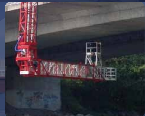
歩廊にて起立させて使用できる、床高さ2mのアシスタントラダーを内蔵。
