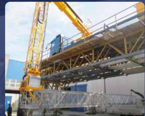
ABC1600の歩廊先端部には、1mの延長床を内蔵
